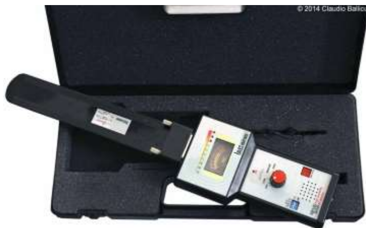
Analizzatori di spettro a radiofrequenza e misuratori dell'intensità di campo elettromagnetico. Apparecchi elettronici usati per la bonifica da microspie
